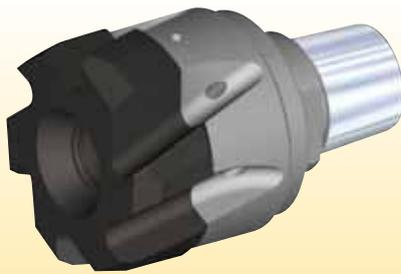
Reibwerkzeug mit spiralförmigen Schneidreihen drückt die Späne unterstützt durch Kühlmittel nach vorn.
