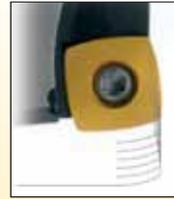
Mit runden Wendeschneidplatten wird im Laufe der Bearbeitung das Spanvolumen größer.
