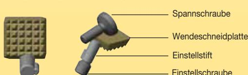
Der Einstellkeil von Kennametal verhindert ein unvorhergesehenes Verdrehen der Wendschneidplatten. Auf diese Weise werden Fehler beim Einrichten vermieden, die zu Beschädigungen des Werkzeugs führen können.
