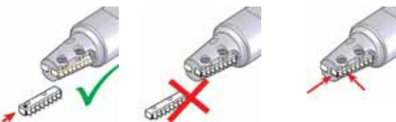
Die Wendeschneidplatten für konische Gewinde müssen mit der Markierung auf der seitliche Fläche nach oben, und mit der Markierung in Richtung der Stirnseite montiert werden.
