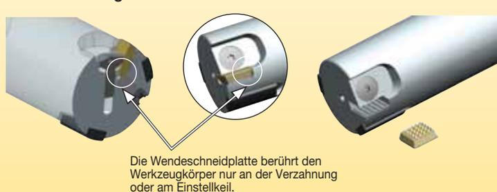
Eine Korrektur der Verjüngung ist nicht erforderlich, da diese bereits durch die Verzahnungen vorgegeben ist. Lediglich der Überstand der Schneidkante bezogen auf die Führungsleisten muss eingestellt werden.
