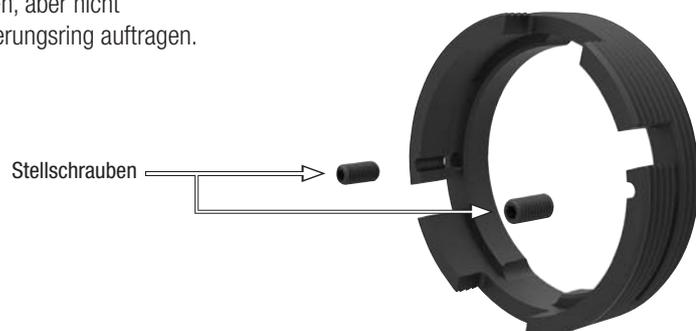
10. Den Kanister-Sicherungsring über den Kanister schieben. Damit dieser die Innengewinde der Spindel berührt, muss unter Umständen das Spindelmontagewerkzeug verwendet werden, um den Kanister-Sicherungsring zu drehen, bis er auf die Orientierungssicherung am Kanister ausgerichtet ist. Sobald der Kanister-Sicherungsring ausgerichtet ist, kann er zurückgeschoben werden, um Kontakt mit den Innengewinden der Spindel herzustellen. Sie können dann den Ring mit dem Spindelmontagewerkzeug festziehen.
